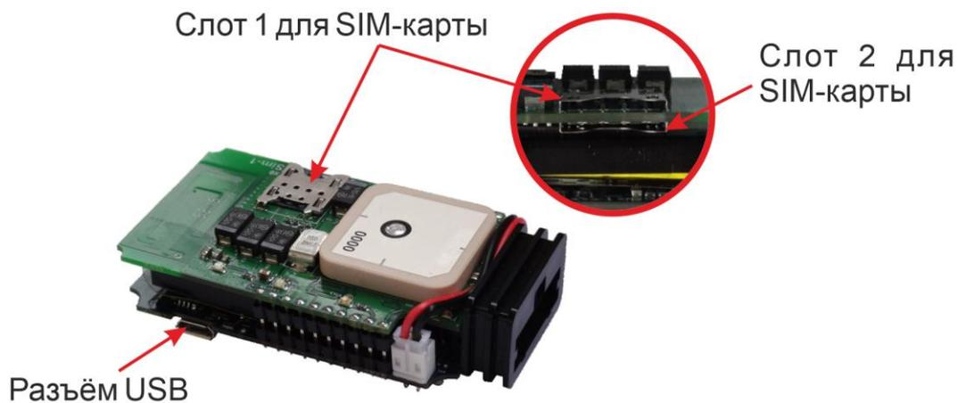
Рис. 3.5. Расположение слотов SIM-карт в терминалах LINE-WAY B
