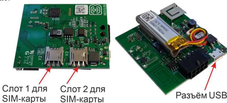
Рис. 3.4. Расположение слотов SIM-карт на терминалах ВЕГА МТ-5
