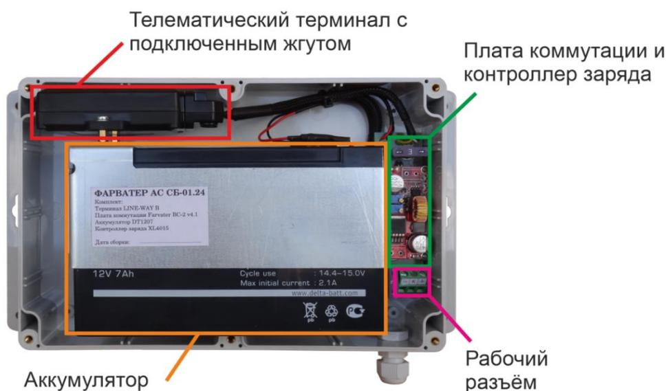
Рис. 3.2. Расположение основных компонентов системы
