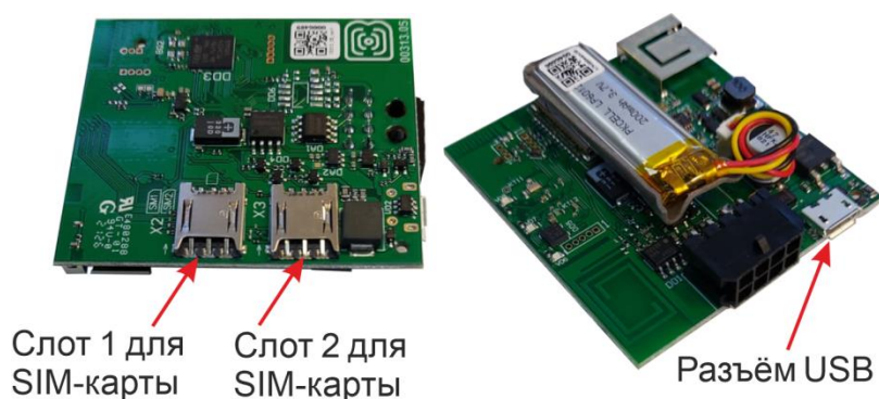
Рис. 3.3. Расположение слотов SIM-карт на блоке ВЕГА МТ-5
