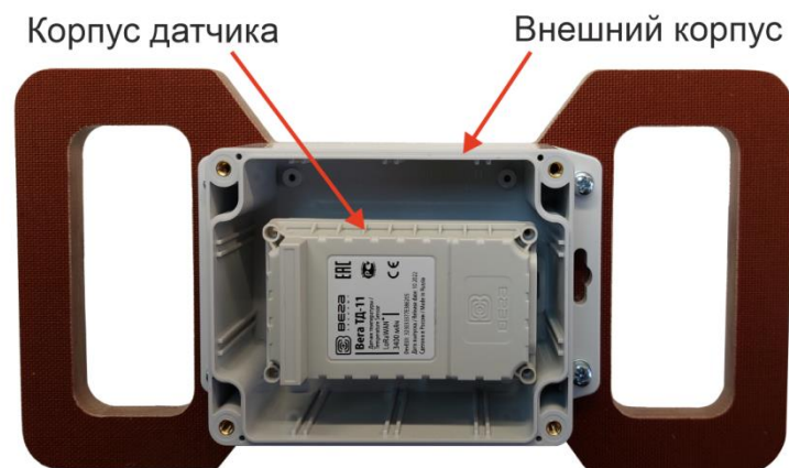
Рис. 3.2. Термодатчик Vega ТД-11 внутри корпуса зонда
