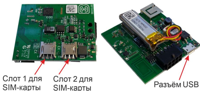
Рис. 3.2. Расположение слотов SIM-карт на плате блока мониторинга зонда
