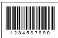
Штрих-код "2of5 Interleaved". Строка данных "1234567890"
