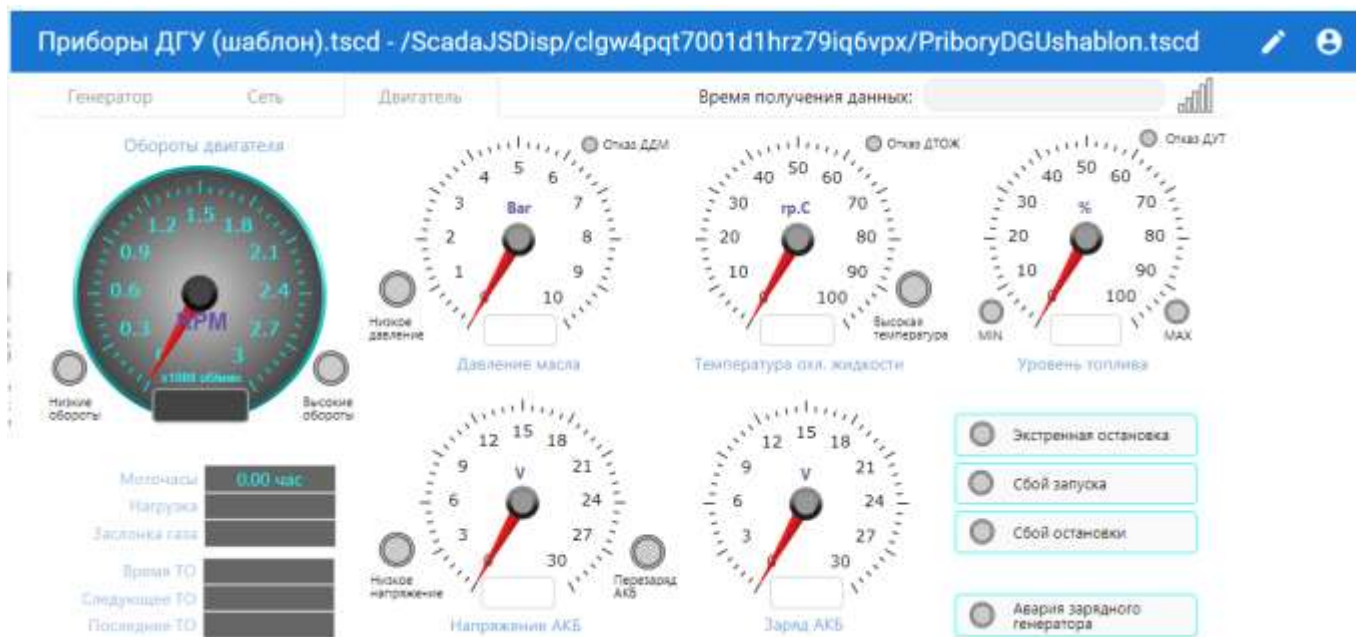
Рисунок 4.4 – Пример просмотра (выполнения) файла SCADA
